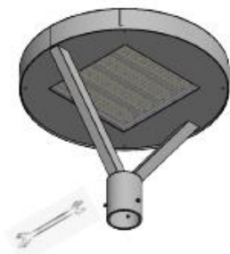
FIGURA (1) COM A CHAVE DE BOCA DESAPERTE OS PARAFUSOS PARA ENCAIXE NO POSTE CIRCULAR.
