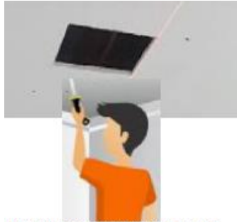
FIGURA (2) FAZER O RECORTE DA SUPERFÍCIE JÁ DEMARCADA.
